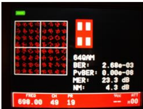
Segnale DVB-T 64 QAM qualità scarsa evidente presenza di rumore
