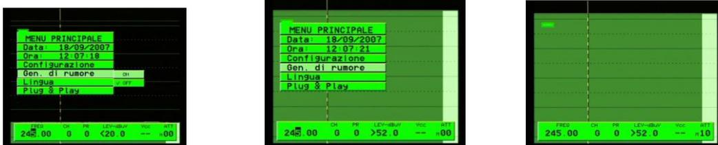
3. Attenuare il segnale in modo da portarlo in una scala leggibile (tramite la pressione sul tasto ATT e ruotando la rotella).
